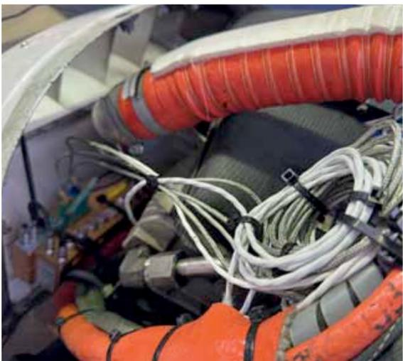
▲ Abbildung 1: Messtechnik im Triebwerk
