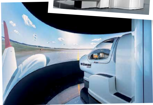
▲ Diamond FNPT II Simulator mit 200 Grad Leinwand, 3 Projektoren und unbeweglicher Zelle
