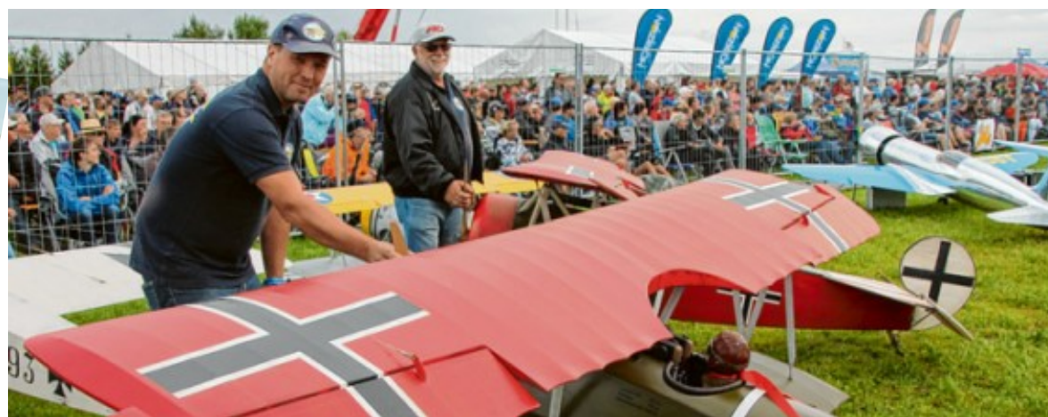
Die Fokker D VI von Gregor Treml (links) wiegt etwa 23 Kilogramm und ist zum größten Teil aus Holz gebaut.
