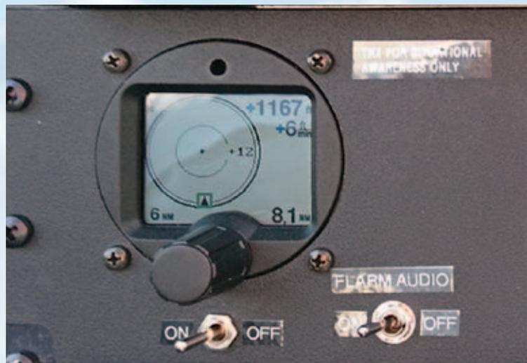
BUTTERFLY-Anzeige von TRX1500-Daten mit ON/OFF-Schalter und zusätzlichem AUDIO-Schalter zur Vermeidung von akustischem „Overload“ im Platzrunden-Schulungsbetrieb
