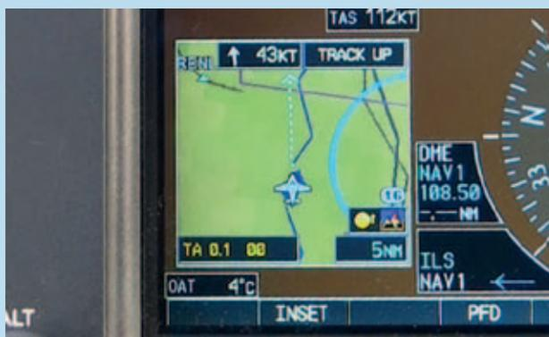
Darstellung eines Transponder-Signals als Traffic Alert (TA) mit Abstand und relativer Höhe mit GARMIN 1000 und TRX-1500
